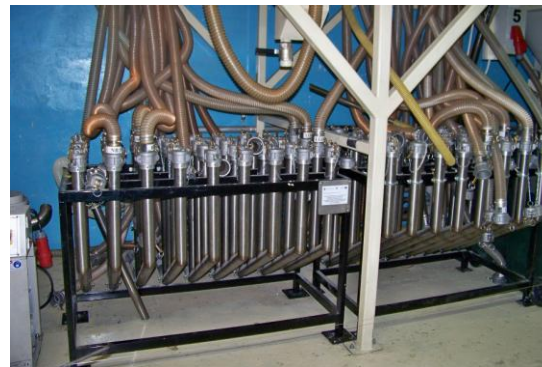
Krosownica – zespół rur rozdzielających materiał do poszczególnych wtryskarek
